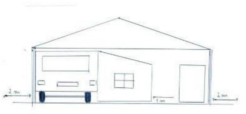
A estrutura metálica deverá ter cobertura da classe M2, sendo de cor verde ou cinza. A sua colocação terá que ter 40 cm, relativamente à caravana e cozinha, e a 2 metros das estruturas envolventes, quer nas frentes, quer nos lados;
